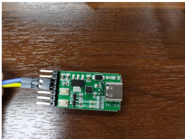
即将发送数据的 TX ( 4 脚) 连接到转换模块的 RX
