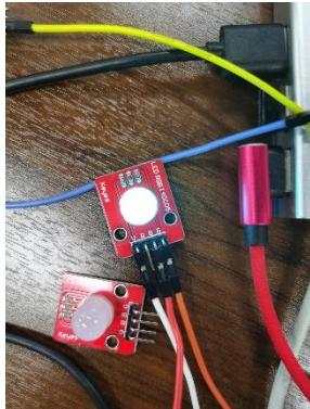
接线：18脚接rgb灯的G段显绿色 19接rgb灯的B段
