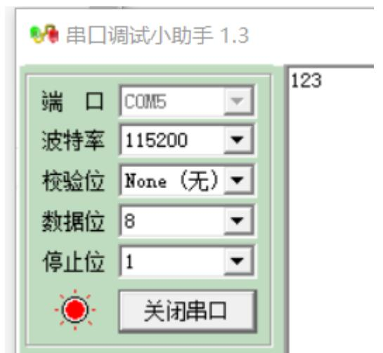
并且通过串口打印到电脑的串口,即可在串口调试小助手接收
