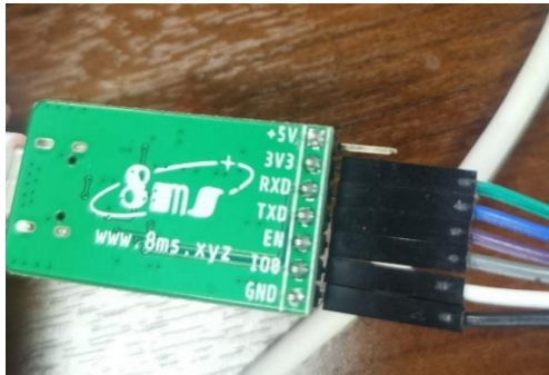
b) USB-TTL 与 C3SI 接线图：
