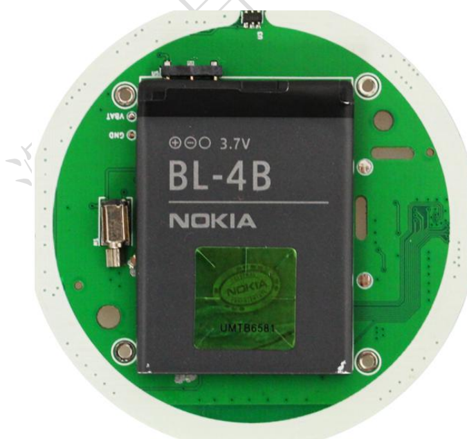
图 4 旋钮屏 PCBA 反面
