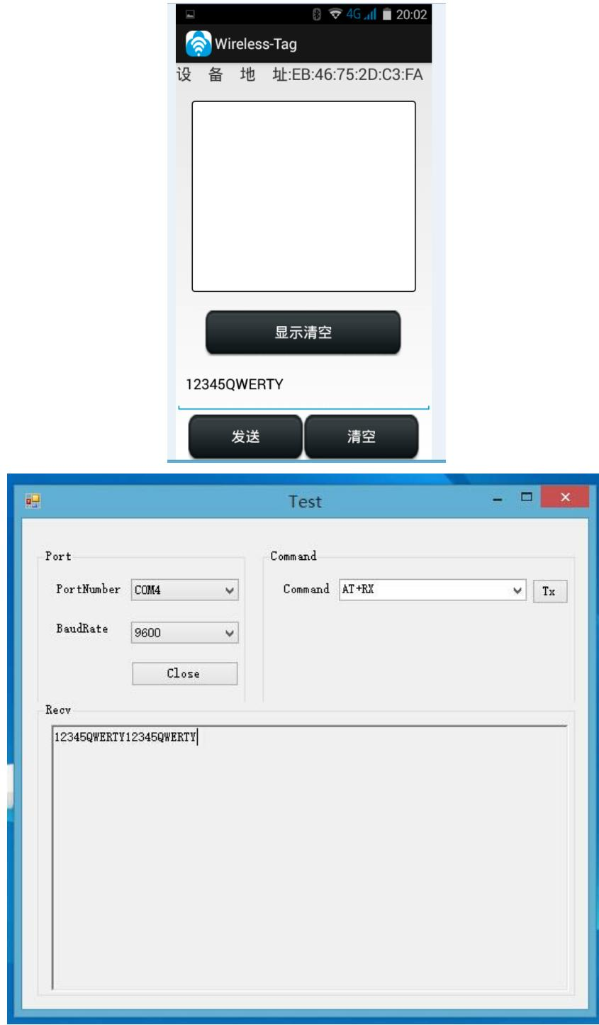
也可以通过 PC 端的串口调试工具，通过模块向 APP 串口工具发送数据，APP 通过显示窗口显示出接收到模块发回的数据：
