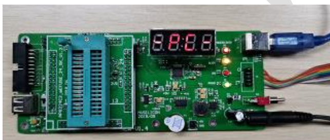
图 2-1 机台用通用烧录器接线
