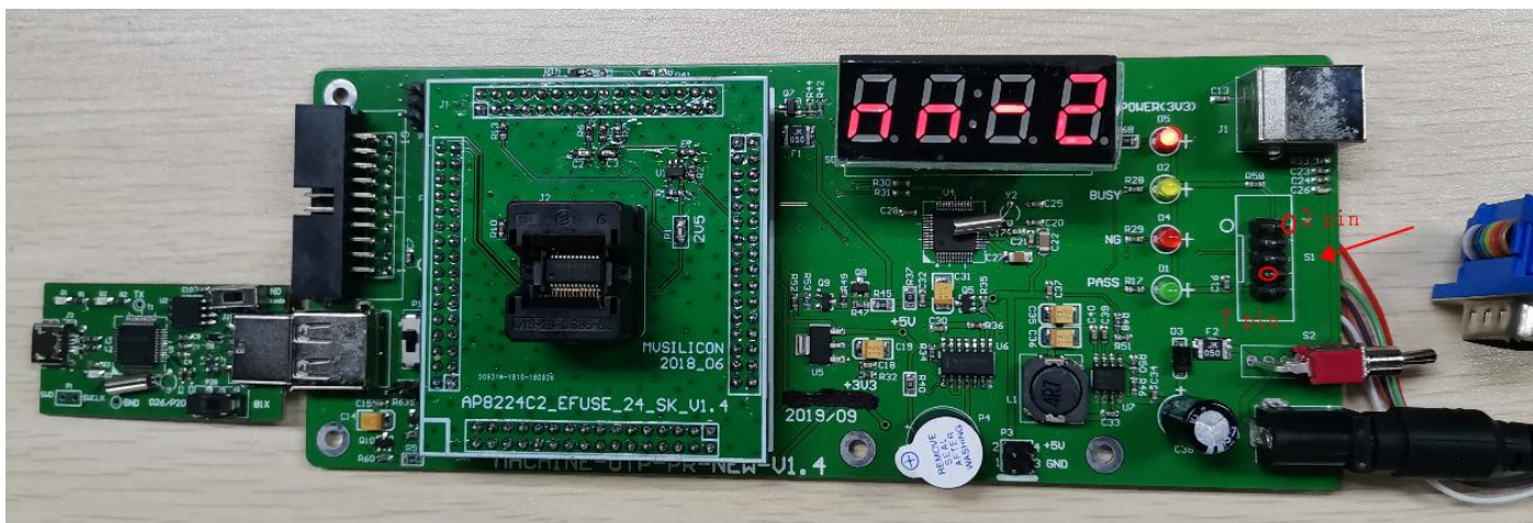
图 1-8 人工手动烧录图示
